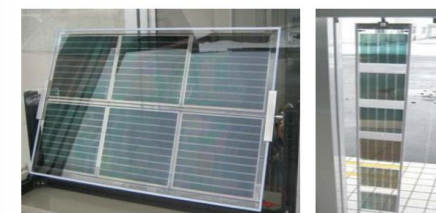
有機薄膜太陽電池試作サンプル（左：パネル型、右：ブラインド型）
